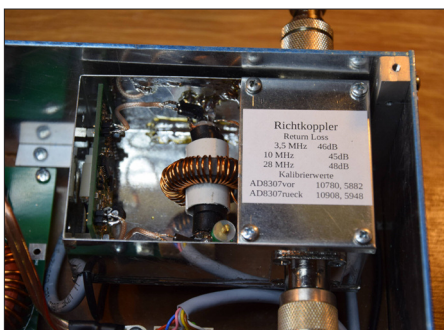
Offenes Richtkopplergehäuse; die linke Seite des Deckels wurde weggelassen, weil die Richtschärfe mit Deckel geringer war als ohne. Alle wichtigen Werte sind auf dem Aufkleber festgehalten.
