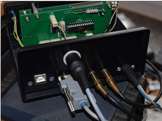
Rückansicht der Fernsteuerung, v. r. n. l.: Stromversorgungsanschluss, RS232-TTL-Schnittstelle zum Split-Filter, RS232-TTL-Schnittstelle zum PicAStar-Eigenbau-Transceiver, DIN-Buchse der Fernsteuerung, RS232-Schnittstelle zum PC mit Software PowerSDR (Hermes), USB-Buchse.
